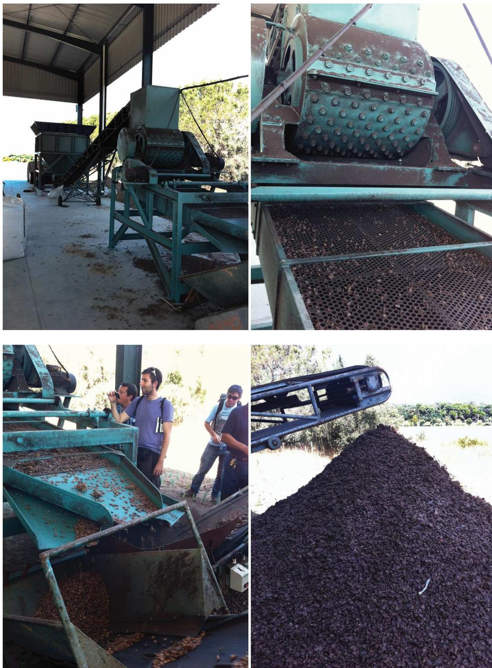
Figura 21 – Pormenores de uma estilhadora/batedora utilizada para destroçar as pinhas abertas e fazer uma primeira separação de pinhão negro e casca de pinha
