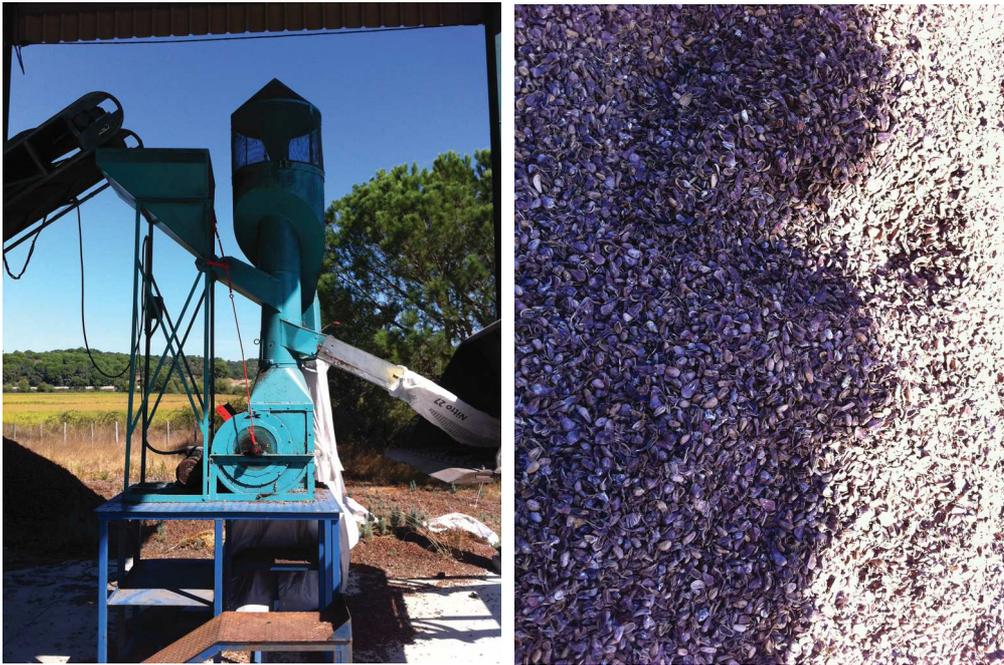
Figura 22 – Pormenor de um separador (turbina) de pinhão negro e casca de dimensão pequena
